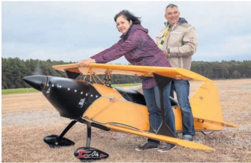
Frank Mader mit seiner Frau bei der Startvorbereitung für die „CHALLENGER“, einem Kunstflug-Doppeldecker mit 2,70 m Spannweite und 24 kg Startgewicht.
